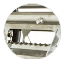
Noże podgrzewane cieżą w obiegu zamkniętym
