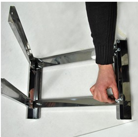
Fot.7. Łączenie nóg i elementów poziomych ze sobą.
