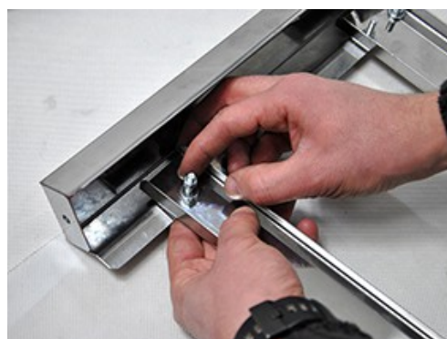
Fot.6. Zakładamy nakrętki i przykręcamy śruby.
