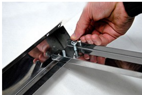
Fot.4. Zakładamy podkładki
