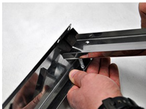
Fot.3. Zakładamy elementy łączące na śruby.
