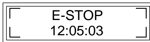
Rys 2. Stan zadziałania pętli bezpieczeństwa
