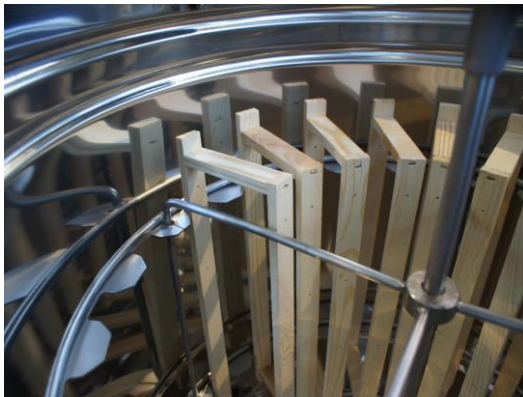
fot.1 Prawidłowe ułożenie ramek w miodarce radialnej
